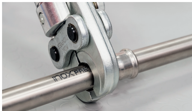
Figure 37 – Réalisation de la connexion à sertir
