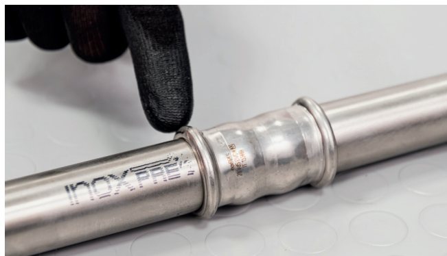
Figure 38 – Contrôle du raccord serté
