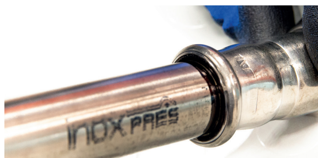
Figure 33 – Exemple de marquage incorrect
