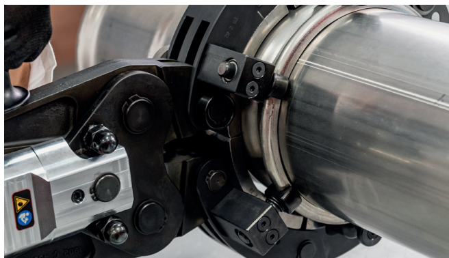
Figure 40 – Phase 2 de l'assemblage par sertissage
