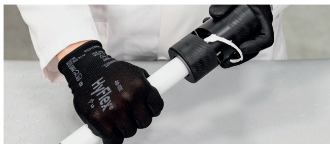
Figure 31 – Dénudage (steelPRES revêtu PP)
