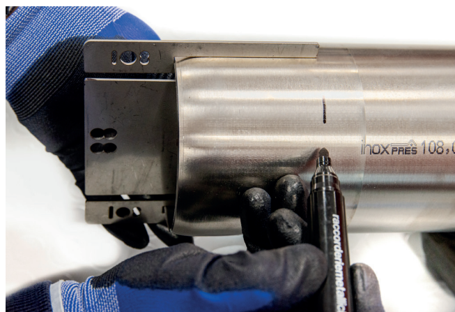
Figure 29 – Marquage de la profondeur d'emboîtement à l'aide d'un marqueur Ø 76 mm - Ø 88 mm - Ø 108 mm
