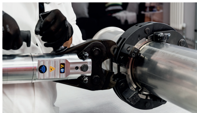
Figure 39 – Phase 1 de l'assemblage par sertissage
